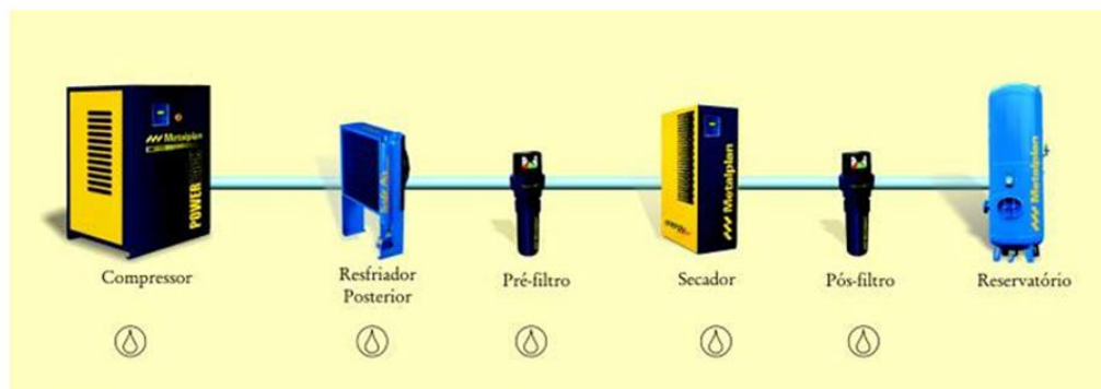
Figura 19 - Produção, distribuição e tratamento do ar comprimido
